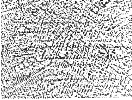
V = 500 : 1 Fe + 4,3 % C Lédéburite : les cristaux \gamma du lédéburite ont la forme dendritique. (fig. 129)
