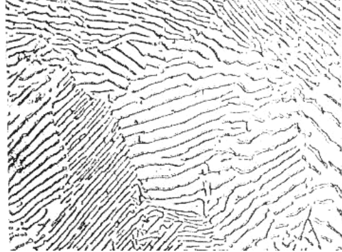
V = 500 : 1 Perlite lamellaire épaisse. (fig. 116)
