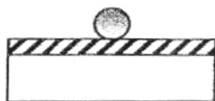
1. Formation de bulles sur le produit de corrosion.
