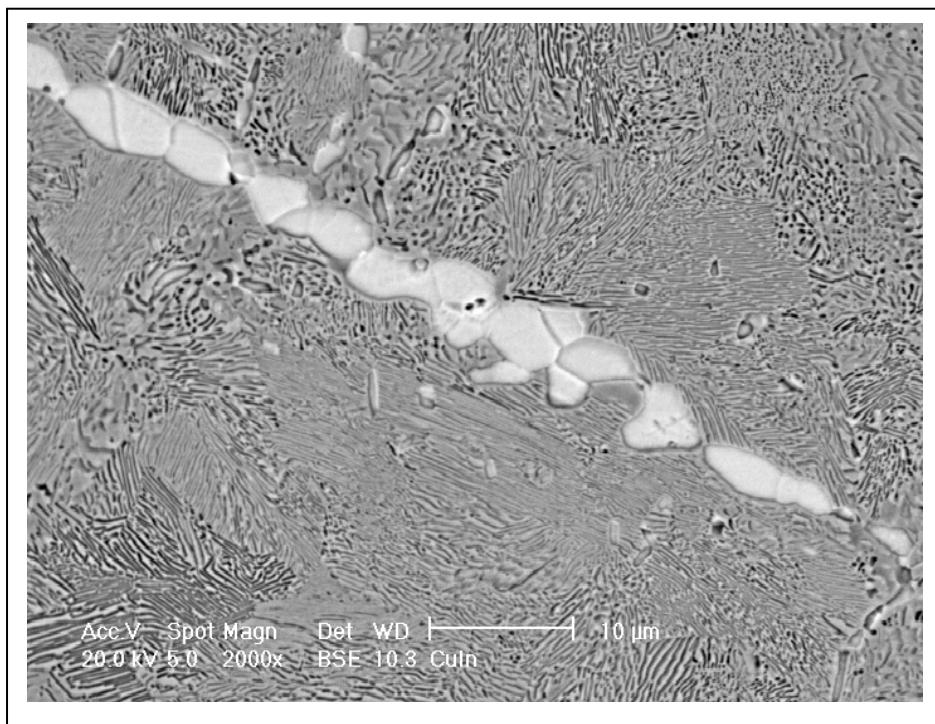
Figure 94. Précipitation lamellaire de part et d'autre de colonies d'eutectique (zones blanches), après Vieillissement à 400°C pendant 10 heures de l'alliage Cu-4,5 at. %In homogénéisé pendant 27 jours à 600°C , trempé dans l'eau glacée
