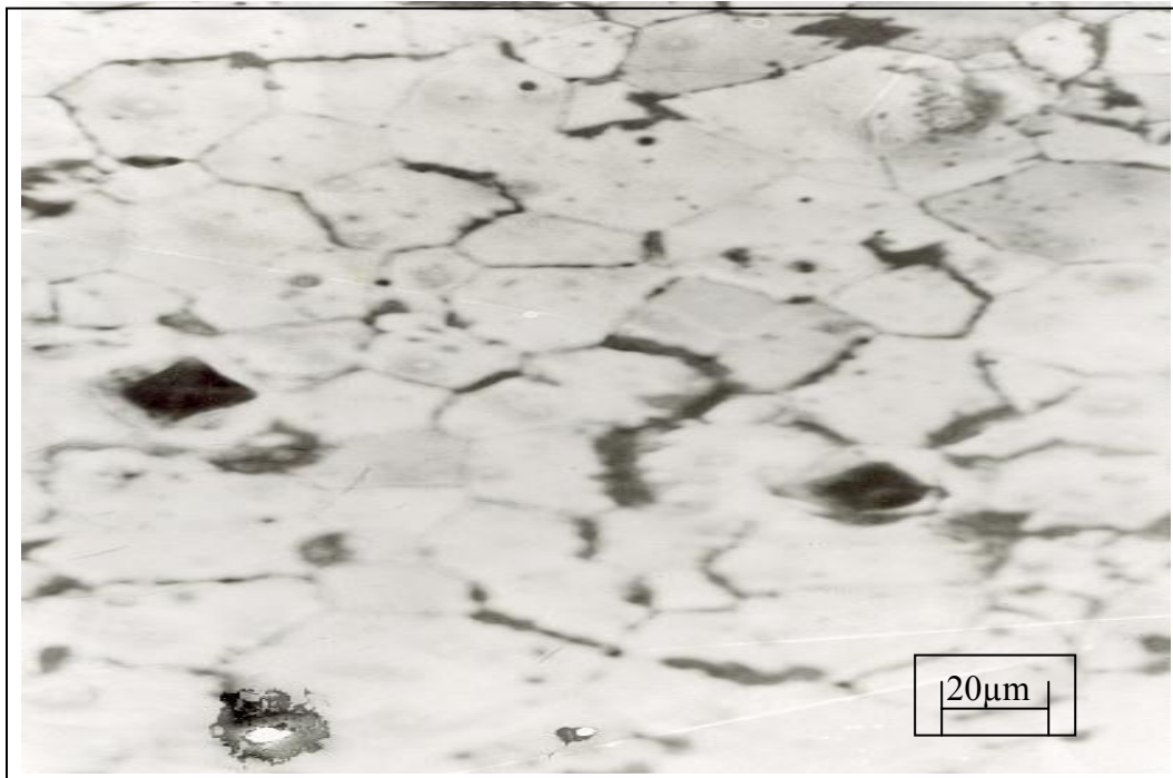
Figure 76. Double couture ou « Mécanismes S » dans l'alliage Al-30 mass.%Zn déformé de 48%, homogénéisé pendant 21 jours à 450^{\circ}\text{C} , trempé dans la glace, ensuite vieilli à 160^{\circ}\text{C} pendant 22 heures
